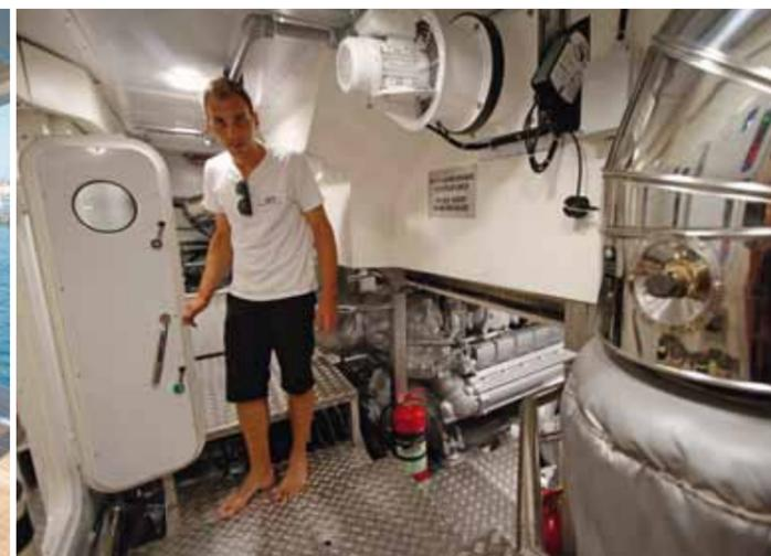
Une porte coupe-feu sépare la salle des machines d'une anti-chambre technique contenant tous les tableaux de contrôle.
