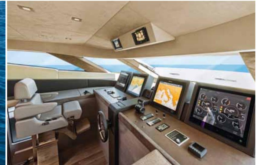
Le poste de pilotage intérieur est de type «pilothouse», autrement dit, surélevé par rapport au pont principal. Il communique aussi avec le fly.
